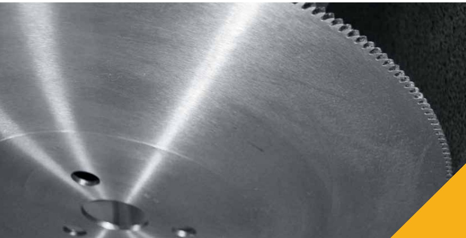
В зависимости от условий работы инструмента полотно изготавливается либо из инструментальной хром-ванадиевой стали (CrV), либо из стали типа 1.2604 (WM70) с повышенным содержанием марганца и вольфрама.
