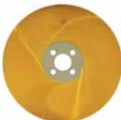
Покрытие на основе классического нитрида титана, которое, благодаря более высокой температуре окисления, позволяет пилить материалы с более высокой прочностью. Покрытие наносится до самого фланца фрезы, что позволяет перетачивать и использовать дисковую фрезу большее количество раз.
