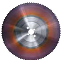
Power Integral имеет особую геометрию тела фрезы – основание имеет большую толщину, тогда как режущая кромка заужена. Это позволяет использовать данный продукт для высокоскоростной резки тонкостенных деталей с высокой чистотой реза.
