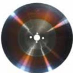
Дисковая фреза Power 2000 – не просто покрытие, а целая концепция специализированного инструмента для резки тонкостенных труб и профиля. Комбинация узкого пропила, низкого коэффициента трения и особой геометрии пилы обеспечивает снижение вибрации, превосходную чистоту реза и снижение риска деформации концов труб.
